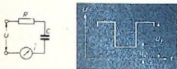
Bild 1. Frequenzbestimmung durch Messen des Ladestromes eines Kondensators
