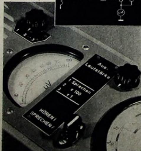
Bild 2. Blick auf die Frontplatte des Antennestgerätes mit Drehschalter (links oben), Meßinstrument, Lautstärkeregl.-Netzschalter und Sprech-taste
