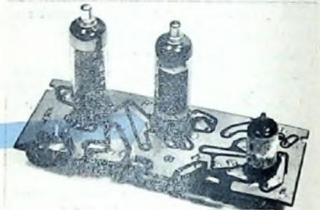
Die Horizontal-Endstufe in gedruckter Schaltungstechnik
