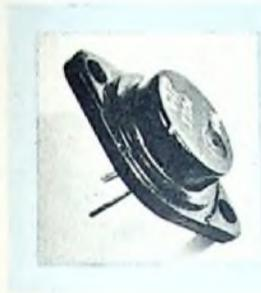
Bild 1. Beispiel der neuen Form von Leistungstransistoren (Intermetall-Transistor CTP 1104)
