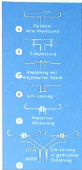
Bild 11. Einige Anpaßmethoden für Dipol-Antennen
