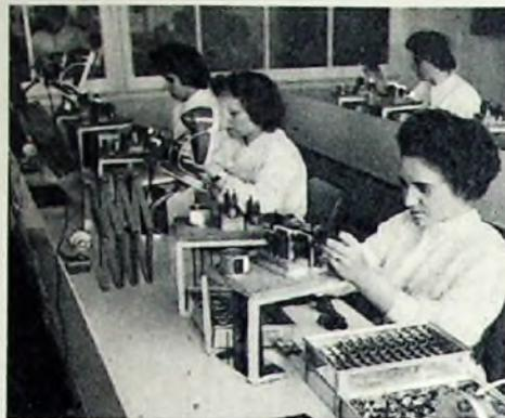
Oben: Einschmelzen der Gitter der Elektronenkanone in Isolatoran. Links: Karussell zum Reinigen der Innenwänden des Bildröhrenkolbens
