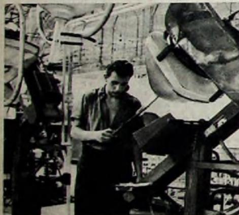
Reinigen des Bildröhrenhalses auf einer Spezialvorrichtung
