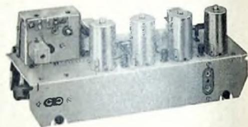
Unten: Rückansicht des Empfängers. An der UKW-Abstimmereinheit ist der Mischtransistor zu erkennen
