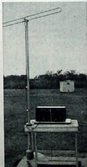
Bild 3. Zu prüfender UKW-Rundfunkempfänger mit Faltdipol; im Hintergrund die Meßkabine
