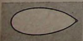
Bild 1. Richtkennlinie, die lediglich aus einer einzigen Hauptkeule besteht
