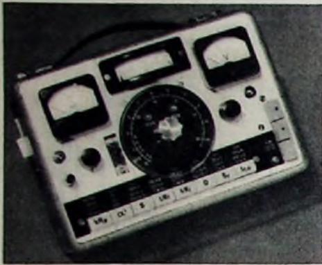
Das Transistor-Meßgerät »teletrans I«
