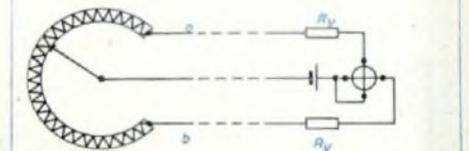
Bild 4. Schaltung mit Anzeige durch ein Kreuzspulinstrument
