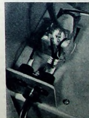
Einbau des Relais in den 2-m-Band-Super
