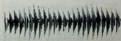
Bild 6. Die Schwingung im Anodenkreis der Strahlableitkathode E80 T (R68) (angestoßener Kreis L9 mit überlagelter Schwebungsfrequenz)
