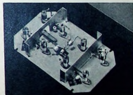
Bild 7. Siemens-Antennenweiche „SAZ 761a“ zum Zusammenschalten von 3 FS-Antennen für Band III, einer Band-I-Antenne und einer UKW-Antenne
