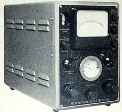
Bild 11. Ausführungsbeispiel eines Trägerschaltungsverstärkers „KWS II“ der Höpinger-Meßtechnik GmbH, der auch den Anschluß von induktiven Gebern an den Meßverstärker erlaubt
