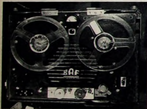
Bild 1. Ansicht des tragbaren Magnetongerates mit eingebautem UKW-Teil. Bild 2 (unten). Unteransicht der Montageplatte vor der Verdrahtung
