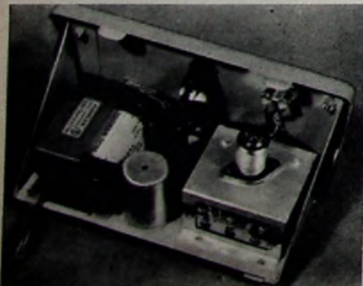
Einzelteilanordnung an der Montageplatte, von vorn gesehen; unten: Chassis des Verstärkers
