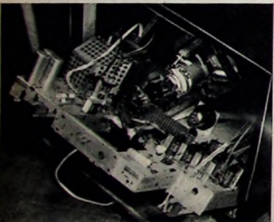
Klappbares Vertikalchassis von Grundig (oben) und von Nordmende (unten)
