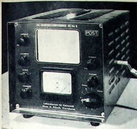
Ansicht des FS-Kontrollempfängers „KE 56 B“
