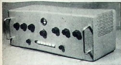
Außenansicht des betriebsfertigen Verstärkers mit PPP-Endstufe
