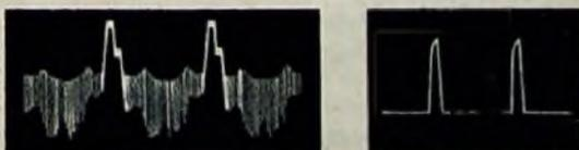
Bild 101 (links). Demoduliertes Fernsehsignal (nach Zeilenfrequenz aufgelöst). Bild 102 (rechts). Oscillogramm der vom Bildinhalt getrennten Zeilensynchronsignale hinter dem Amplitudensieb des Fernsehempfängers
