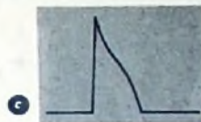
Bild 4. Sperrschwinger; a = selbstschwingend, b = getriggert, c = Sperrschwingerimpuls
