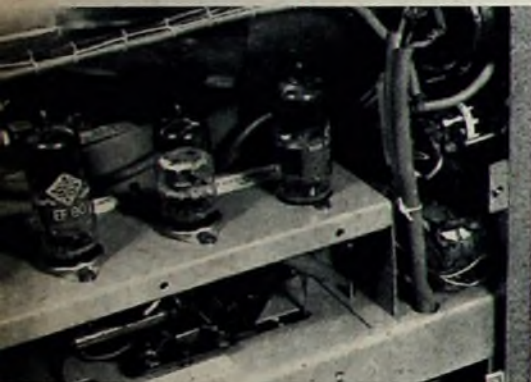
Kippgerät und X-Verstärker bei abgenommener Seitenwand. Die Durchführungsschlitze und die Lötösenleiste auf dem Gesamtchassis sind deutlich erkennbar.
