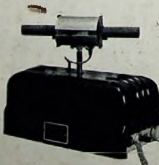
Die abstimmbare Ferritantenne „Selektor 58 W“ mit eingebautem HF-Verstärker (EF 85)
