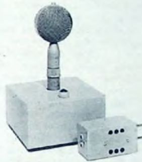
Bild 2. Ansicht des Verstärkers mit aufgesetzter Mikrofonkapsel und besonderem Heiztransformator
