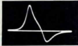
Diskriminatorcurve. Unsymmetrien werden durch die Basislinie gut erkennbar
