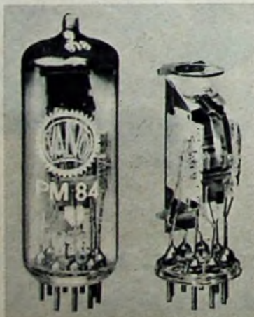
Abstimmanzeigeröhre PM 84. Rechts: das aus dem Kolben genommene System (Aufnahme: Valvo GmbH)
