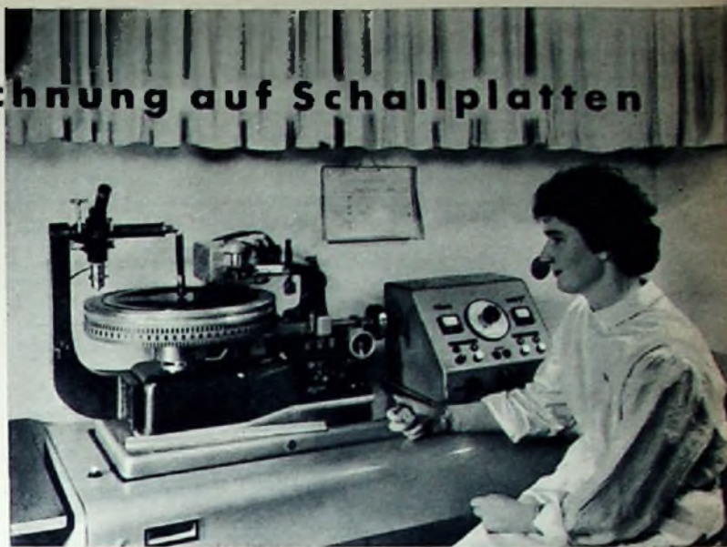
Aufnahmeanlage für stereophonische Schallplattenaufzeichnung im Berliner Studio der Teldec
