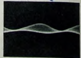
Oszillogramm am Punkt D, Feinabstimmung verstimmt
