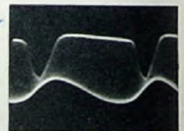
Oszillogramm am Punkt D, richtige Abstimmung (über Bildfrequenz)
