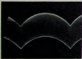
Oszillogramm am Punkt C (über Bildfrequenz)
