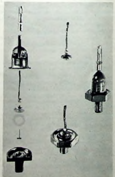
Bild 3. Aufbau der Silizium-Leistungsgleichrichter von Eberle
