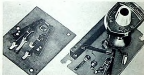
Bild 9. Prinzipschema des „Zeitautomaten“ von Nordmende. Bild 10 (unten). Unter- und Oberansicht
