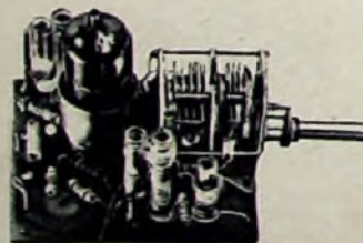
Bild 2. UKW-Einheit von Loewe-Opta in gedruckter Schaltung (siehe auch Titelbild des Heftes 13/58)
