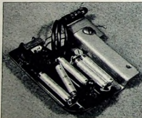
Ansicht der Montageplatte II mit dreistufigem Modulator. Der Endtransistor OC 604 spez. ist mit seiner Kühlfläche am Metall-Montagewinkel befestigt
