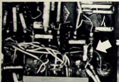
Schaltung zum Mithören über eingebauten Lautsprecher beim „KL 65 X“
