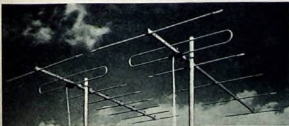
Die neue 6-Element-Antenne „Fesa 6 D“ (rechts) von Hirschmann mit vergrößerten Abständen zwischen den Direktoren hat mit 9 dB etwa den gleichen Gewinn wie eine bisherige Antenne mit 8 Elementen (links); beide Antennen sind ungefähr gleich lang
