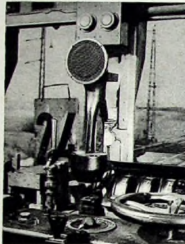
Bild 4 (links). Funksprecheinrichtung und Bedienungsgerät am Führerstand in der elektrischen Lokomotive. Bild 5 (rechts). Mikrophon-Lautsprecher und Sprechaste auf dem Lok-Führerstand
