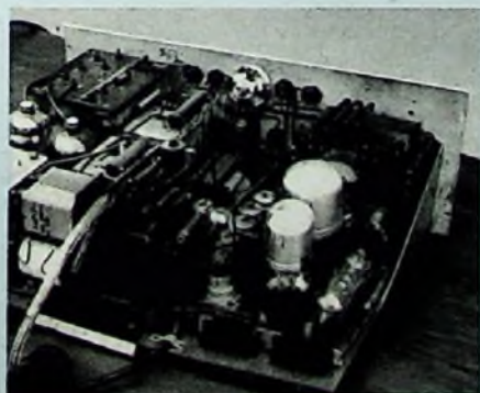
Bild 18. Einschub mit Modulator - Endstufe (vorn links), Antennen-Multibandkreis mit Relais (rechts); Tiefpaß und Abschirmungen sind entfernt
