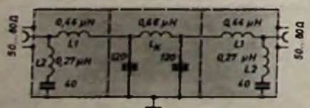
Bild 12. Tiefpaßfilter für 60 dB Dämpfung; Frequenzbereich: < 35 ... 41 MHz
