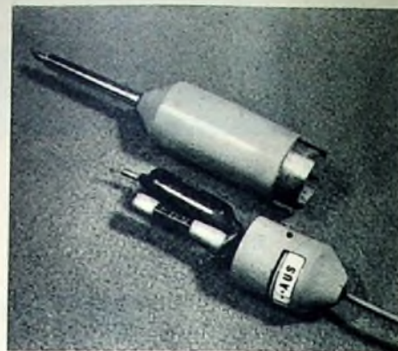
Bild 4. Gesamtansicht des Tastkopfes (Kappe abgenommen)
