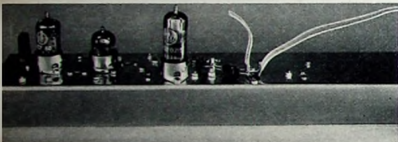
Bild 3 (oben). Der obere Chassisaufbau des Kleinsenders Bild 4 (unten). Blick in die Verdrahtung
