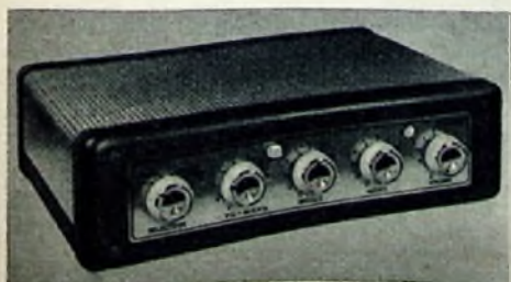
Ultralinear-Verstärker (Thorens) für maximal 18 W; Frequenzbereich des Verstärkers 20... 20000 Hz \pm 1,5 dB, Klirrfaktor bei 1 kHz Vollast < 1%, 5 Eingänge
