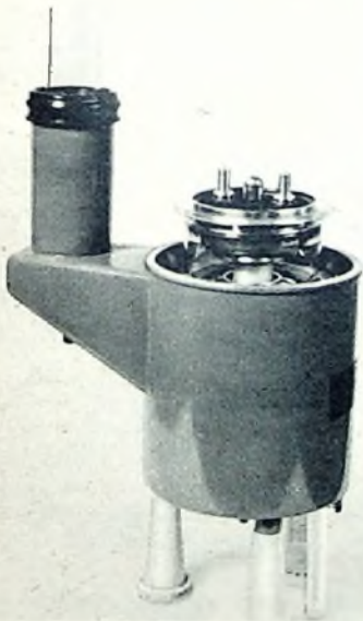
Kaltkathodenröhre der Elesta als Steuerorgan in einem Ionisationskammer-Zeitrelais für regelbare Zeitbereiche von 13 Sekunden bis 4 Stunden
