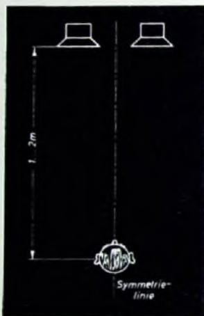
Bild 3. Anordnung der beiden Lautsprecher für den Phasentest
