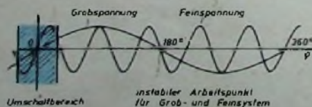
Bild 27. Ausgangsspannungen des Grob- und Feinsystems bei einem Übersetzungsverhältnis 1:5
