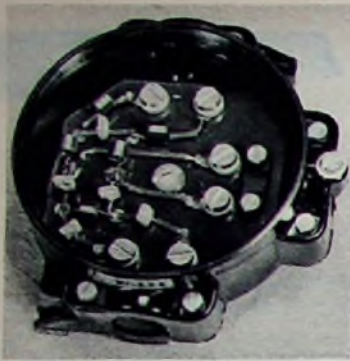
Bild 20. Frequenzweiche „6025“ (Engels) für Ausgang 240 Ohm. Anschlüsse: unten = FS-Band-III-Antenne; oben = UKW-Antenne; rechts = 240-Ohm-Ausgang
