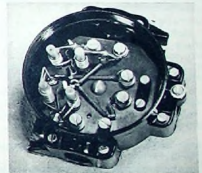
Bild 28. Frequenzweiche „7091“ für zwei FS-Antennen im Band III. Oben = Band III, K 11, 240 Ohm; unten = Band III, K 5...9, 240 Ohm; rechts = gemeinsamer Ausgang mit 240 Ohm Impedanz
