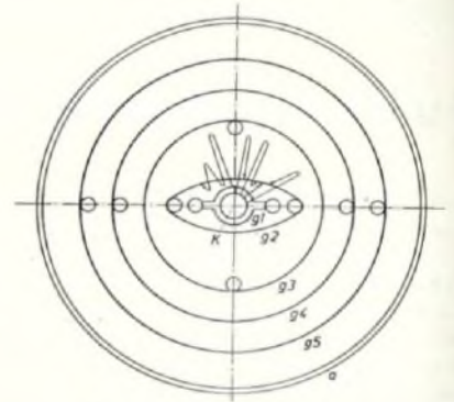
Bild 2. Querschnitt durch eine Doppelsteuerröhre mit negativem Gitter g3, wodurch Elektronenumkehr (Pendelbewegung wie eingezeichnet) hervorgerufen wird
