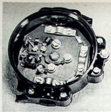
Bild 20. Frequenzweiche „6025“ (Engels) für Ausgang 240 Ohm. Anschlüsse: unten = FS-Band-III-Antenne; oben = UKW-Antenne; rechts = 240-Ohm-Ausgang
