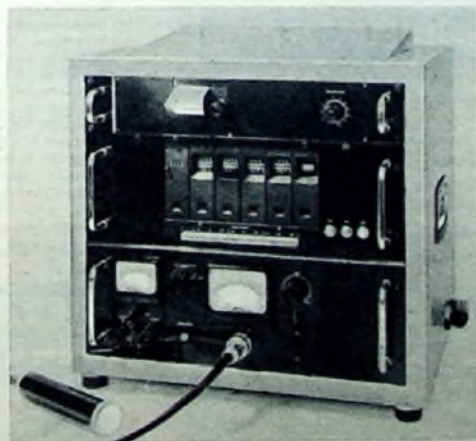
Bild 3.16. Ansicht eines Strahlungsmeßplatzes nach dem Bausteinprinzip mit Zählereinrichtung und Ratemeter (Philips)
