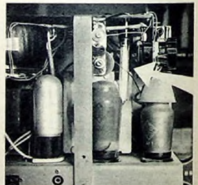
Bild 2. Amplituden-Glimmröhre zur Schmalband-Frequenzmodulation in einem Amateursender
