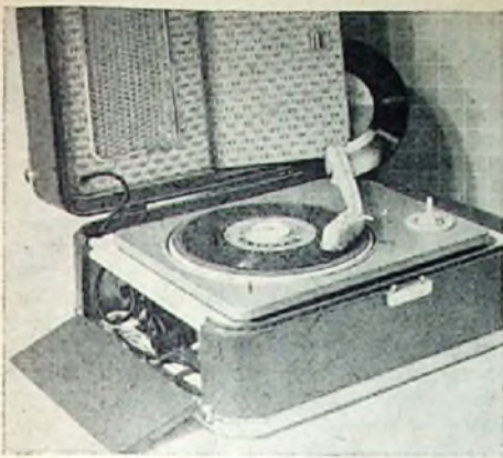
Phono-Koffer „Toscana“ von K. Ehrlich und Schaltung des Einröhrenverstärkers
