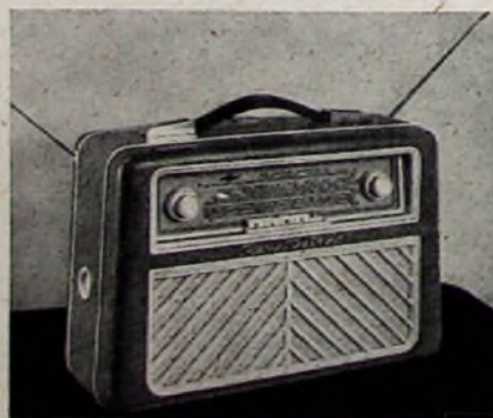
„Stern 1“, der gemischtbestückte Reiseempfänger von VEB Stern-Radio Rochlitz. Links außen: Blick in das geöffnete Gehäuse des Empfängers ◀
