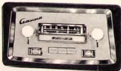
Bild 5. Empfangsteil mit Bedienungsfeld der Omnibus-Anlage „Gamma Tourist T“ von Wandel u. Goltermann
