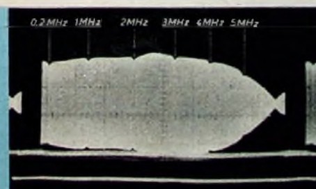
Bild 12. Oszillogramm des Video-Frequenzganges am Gitter 1 der Bildröhre bei gedrückter Taste „Film“
