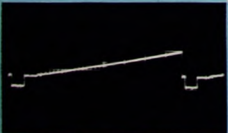
Bild 5. Sägezahnoszillogramm am Ausgang des Video-Verstärkers (PCL 84) 20 V ss
