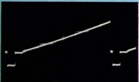
Bild 4. Sägezahnoszillogramm am Ausgang des Video-Verstärkers (PCL 84) 40 V ss
