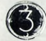
Ziffern-Anzeigeröhre Z 510 M (Valvo)
