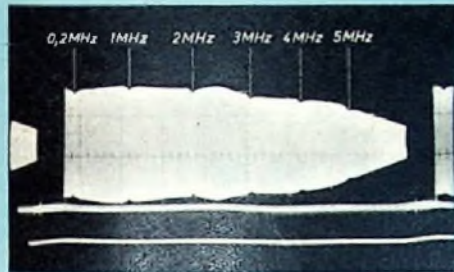
Bild 10. Oszillogramm des Video-Frequenzganges am Ausgang des Video-Verstärkers (g1 Bildröhre) mit den Widerständen R 14, R 15 und den Drosseln L 5, L 6
