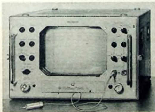
Bild 8. Zweikanal-Frequenzgang-Sichtgerät „Polyskop SWOB“ für Zweipol- und Vierpolmessungen von Rohde & Schwarz
