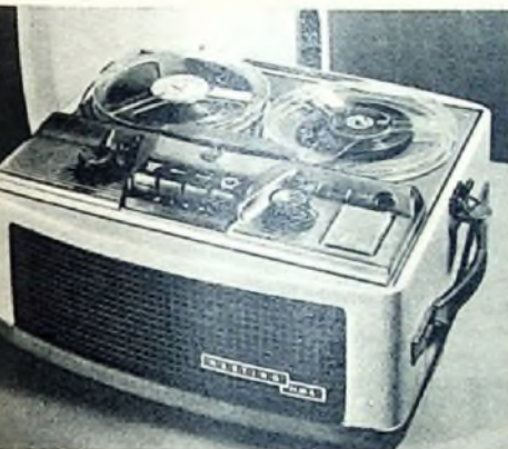
Tonbandgerät „HM 4“ für 9,5 und 19 cm/s (Harting)
