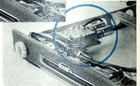
Bild 2. Chassis mit eingebautem UHF-Tuner
