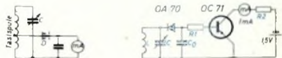
Bild 1 (links): Übliche Schaltung eines Absorptionswellenmessers mit Kristalldiode. Bild 2 (rechts): Die Empfindlichkeit des Wellenmessers läßt sich durch einen den Gleichstrom der Diode verstärkenden Transistor steigern.
