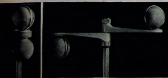
Stereo-Mikrofon „MDS 1“ von Sennheiser electronic. Ganz links: Tragarme übereinander liegend; ◀ daneben: Tragarme gespreizt
