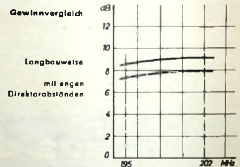
6-Element-Antenne in Hirschmann-Longbauweise Gewinn: 9 dB
