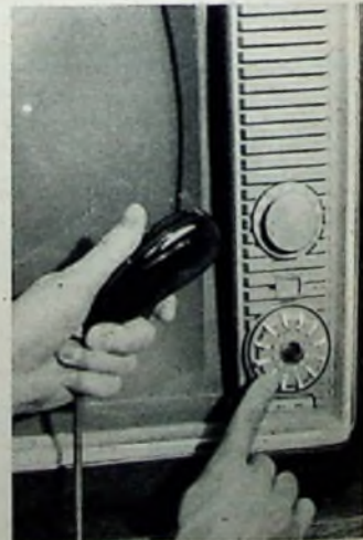
Links: Chassis des Telefunken-Fernsehempfängers „FE 20/53 TM“ mit motorisierter Senderwahl. Mitte: Detail-Chassisansicht „FE 20/53 TM“ (von oben nach unten: Automatikschaltung für horizontalen und vertikalen Bildfang, UHF-Empfangsteil, motorisch angetriebener Kanalwähler für Band I und II). Rechts: Einstellkranz des „FE 20/53 TM“; durch Drücken der Tasten „Motor“ am Gerät oder der Fernbedienung werden die vorgewählten Kanäle nacheinander eingestellt
