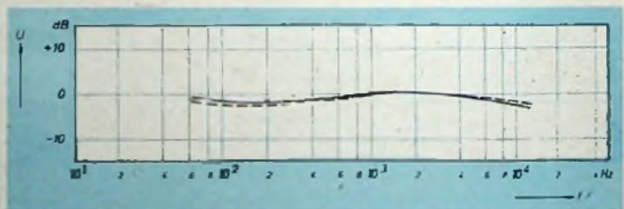
Bild 5. Frequenzgang des „DMS 900“, gemessen über Vorverstärker „TVV 40“ (0 dB = 140 \text{ mV/cm s}^{-1} , — linker Kanal, - - - - - rechter Kanal)
