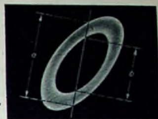
Bild 5. Ring-Oszillogramm durch phasenverschobene Trägerfrequenzspannungen an den Plattenpaaren
