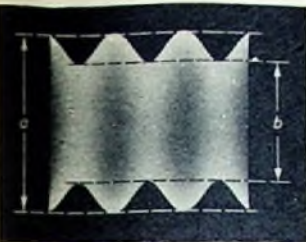
Bild 2. Zeitlineare Horizontalablenkung mit einem Bruchteil ( 1/3 ) der Modulationsfrequenz
