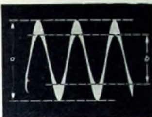
Bild 3. Zeitlineare Horizontalablenkung mit einem Bruchteil ( 1/3 ) der Trägerfrequenz
