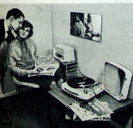
Bild 1b. Ansicht einer Anlage nach dem Schema von Bild 1a, jedoch erfolgt hier die Wiedergabe des linken Kanals über den Rundfunkempfänger (Kleinsuper „Philetta de Luxe“) und des rechten Kanals über den Lautsprecher des Phonokoffers (Phonokoffer III „SK 55“)
