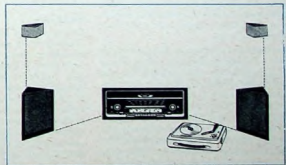
Bild 4. Schema einer Stereo-Hi-Fi-Anlage mit Rundfunkempfänger als Steuergerät (in der Mitte) und je einer Baßreflexbox und einem Höhenstrahler links und rechts. Im Vordergrund das Hi-Fi-Stereo-Abspielgerät, z. B. „SK 45“
