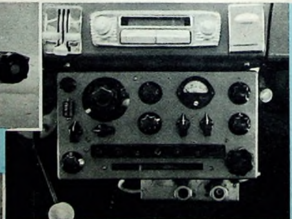
Mobilstation für alle Bänder (80; 40, 20, 15, 10 und 2 m) von DL 3 FO
