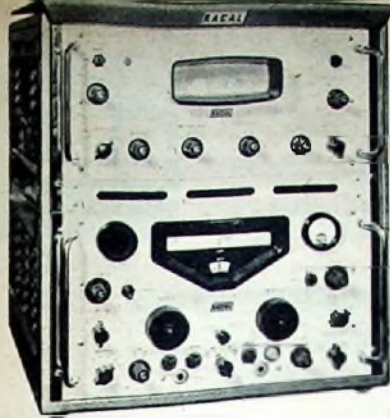
Bild 3. Panorama-Empfänger „RA 81“ der Firma Racal, bestehend aus dem Funkverkehrs-Empfänger „RA 17“ (unten) und dem Panoramazusatz „RA 66“ (oben). Frequenzbereich 1...30 MHz, sichtbare Bandbreite stetig veränderbar von 100 kHz bis 1,04 MHz innerhalb des gesamten Frequenzbereiches
