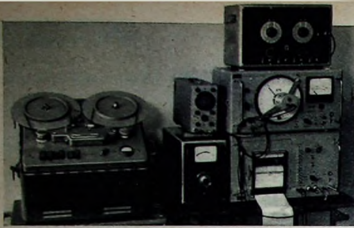
Vollständige Meßanordnung für die Untersuchung von Schwingungen. Links: „Magnetophon M 5 M“; rechts von oben nach unten: Impuls- und Rechteckgenerator (Philips), Tonfrequenz-Analysator (Rohde & Schwarz), Gleichspannungsschreiber (Rohde & Schwarz); links daneben: Trägerfrequenzverstärker (Halling), und darüber Kleinszilograf (Siemens)
