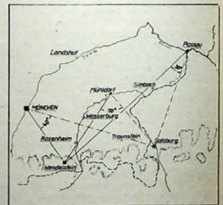
Bild 3. Winkel zwischen den Einfallrichtungen zweier Fernsehsender in einigen Städten
