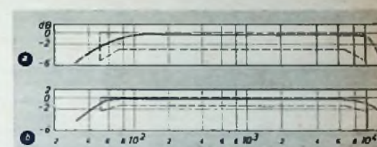
Bild 3. Frequenzgang des „Stellavox SM 4“; Aufnahme und Wiedergabe (a), Wiedergabe von Testband (b)
