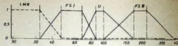
Bild 9. Idealkennlinien der Weiche „Awe 60 B 123“
