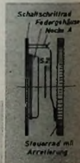
Bild 10. Detailskizze zur Erläuterung der Funktionen des Steuergerätes und des Schaltschrittrades im Steuergerät des „620“ (Wisi) ▶ Bild 11 (links unten). Schaltung des Steuergerätes und des Rotorteiles zum „620“. Bild 12 (unten rechts). Ansicht des Antennenrotors „620“
