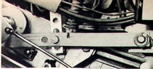
Bild 3. Gestänge der Fühlhebelbremse für konstanten Bandzug
