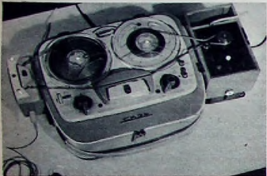
Bild 6. Playback-Vertonung mit Hilfe des Aufnahme-Kontrollgeräts „AK 2“ (rechts der Tonkoppler für die Synchronisierung eines Schmalfilmprojektors)
