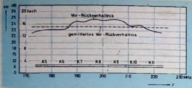
Bild 11. Vor-Rückverhältnis der Breitband-Antenne „6511“ im FS-Band III (174...223 MHz)
