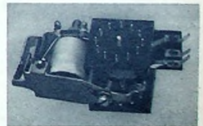
Bild 50. Untersicht der industriell hergestellten elektromechanischen Steuerung „Kinematic“ von Graupner
