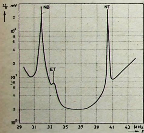
Bild 4. Durchlaßkurve des Bandfilters BF I im „864“ von Metz
