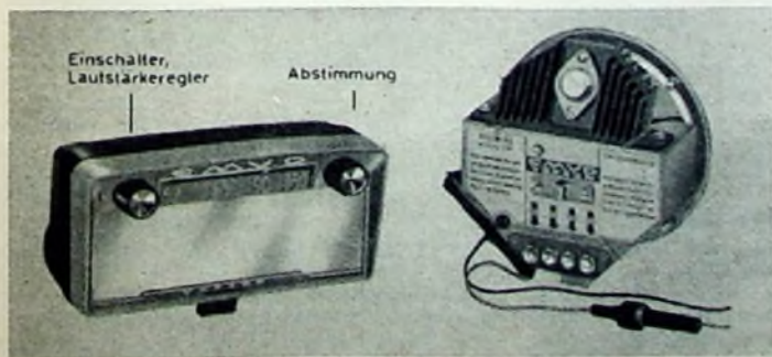
„Emud-Vorson-Transistor-Autosuper“; ganz links der Empfängerteil in Form eines Rückspiegels, rechts daneben Lautsprecherteil
