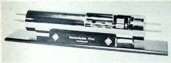
Bild 6. Aufbau eines mechanischen Filters
