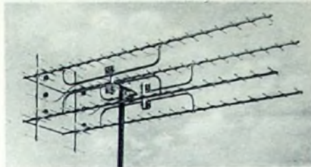
Bild 5. Hochleistungsantenne „FW 423 RBA“ mit 96 Elementen (Deutsche Elektronik)
