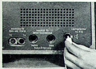
Rückseite eines Grundig-Stereo-Tischempfängers mit Normbuchsen für TB, TA und Lautsprecher
